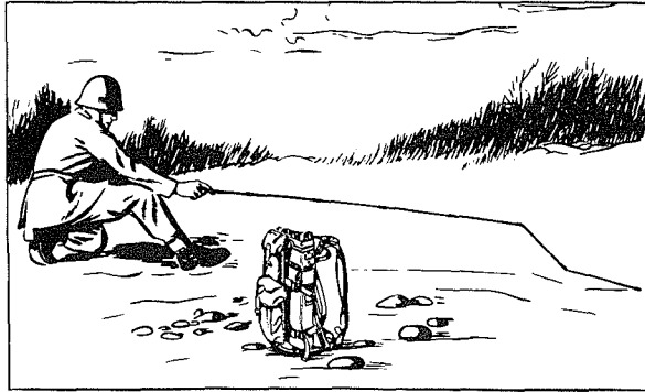
Bild 17. Hopsättning av normalantenn
